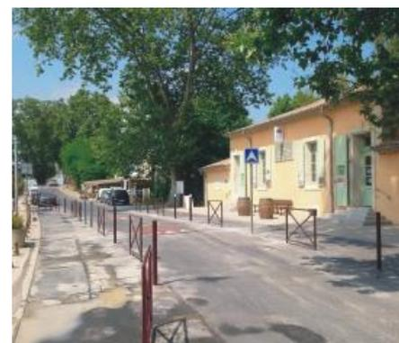
Un aménagement de type "écluse" (au bord du Canal, c'est particulièrement adapté !) a été mis en place au niveau de la Maison Cantonnière, pour réduire la vitesse des véhicules et permettre un meilleur partage de la chaussée entre usagers (avec l'élargissement du cheminement piéton). Cet aménagement a été réalisé suite aux demandes formulées par les riverains et les responsables de l'Office de Tourisme.
